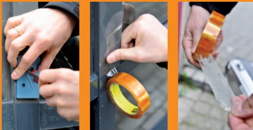
Bij deze test met de dubbele kruissnede komt teveel ondergrond mee, dus ongeschikt voor foliemontage.
