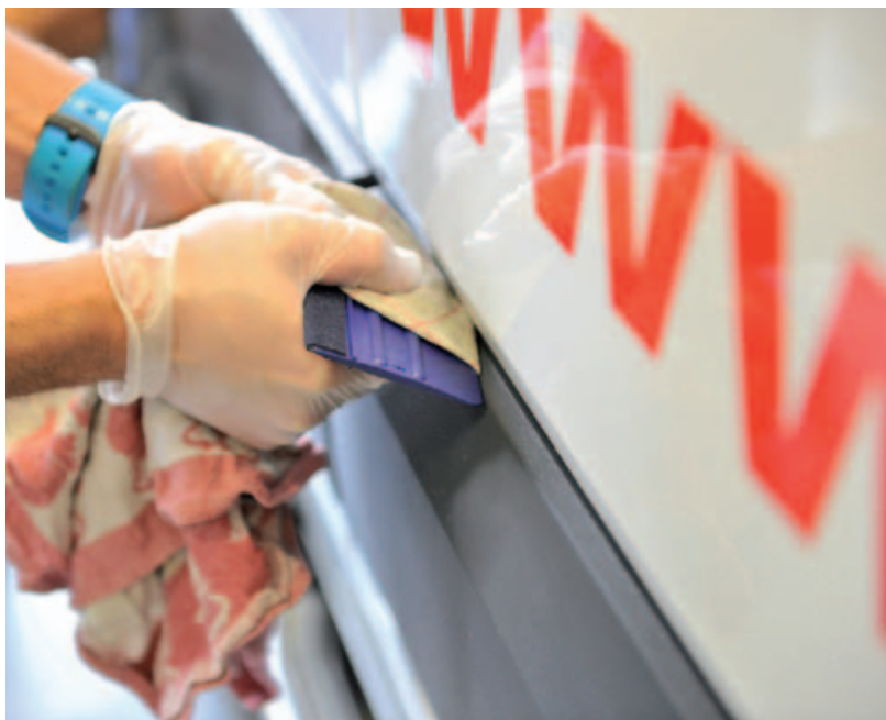
Reinigingstip: haal een rakel met dun en goed absorberend papier door smalle randen.
