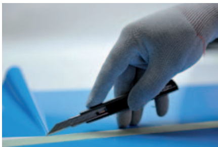
Foto 1: Een ritsmes moet je zo vlak mogelijk ten opzichte van de ondergrond houden, zodat de punt van het mesje naar voren wijst.
