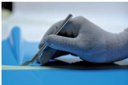
Foto 2: Een scalpelmes houd je in de hand alsof je een pen vasthoudt. Klem het mesje zo in de houder dat de punt naar voren wijst.
