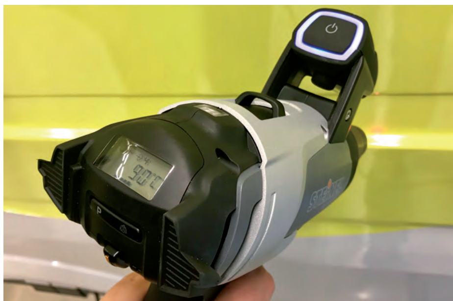
Op deze heatgun kan de gewenste ondergrondtemperatuur worden ingesteld. Zodra die is bereikt, wordt de warmte-uitstoot minder heet.
