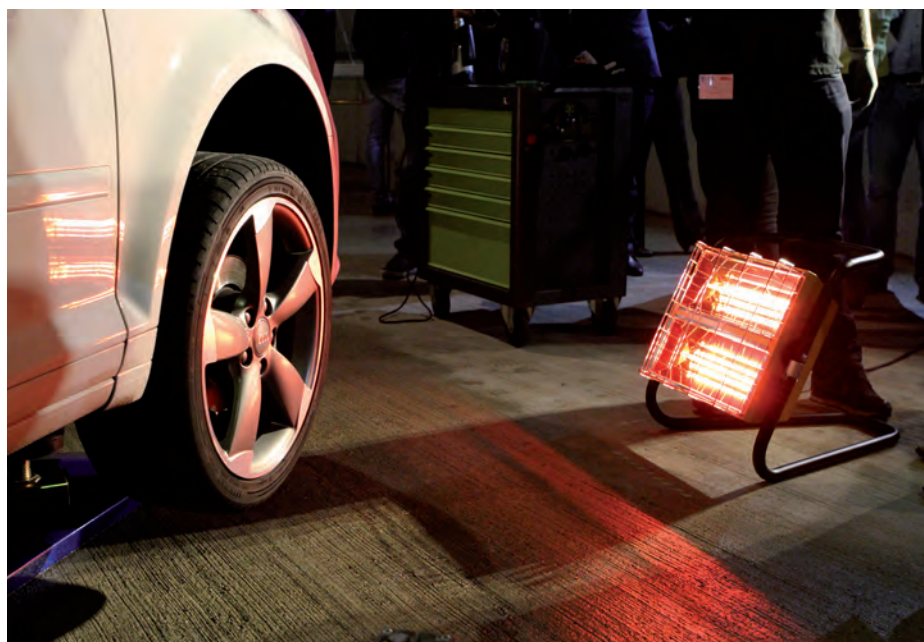
Een infraroodheater verwarmt - anders dan een heatgun - niet de lucht, maar de objecten in een ruimte en je hebt de handen vrij.
