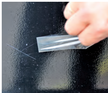
▲ Met een enkele andreaskruissnede test je of een geschilderde ondergrond geschikt is voor foliemontage.
