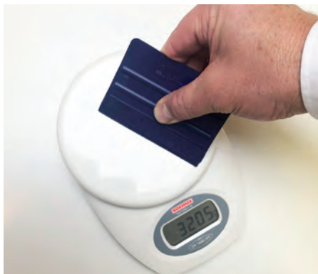
Folie moet met ongeveer 3 kilogram druk worden aangerakeld.
