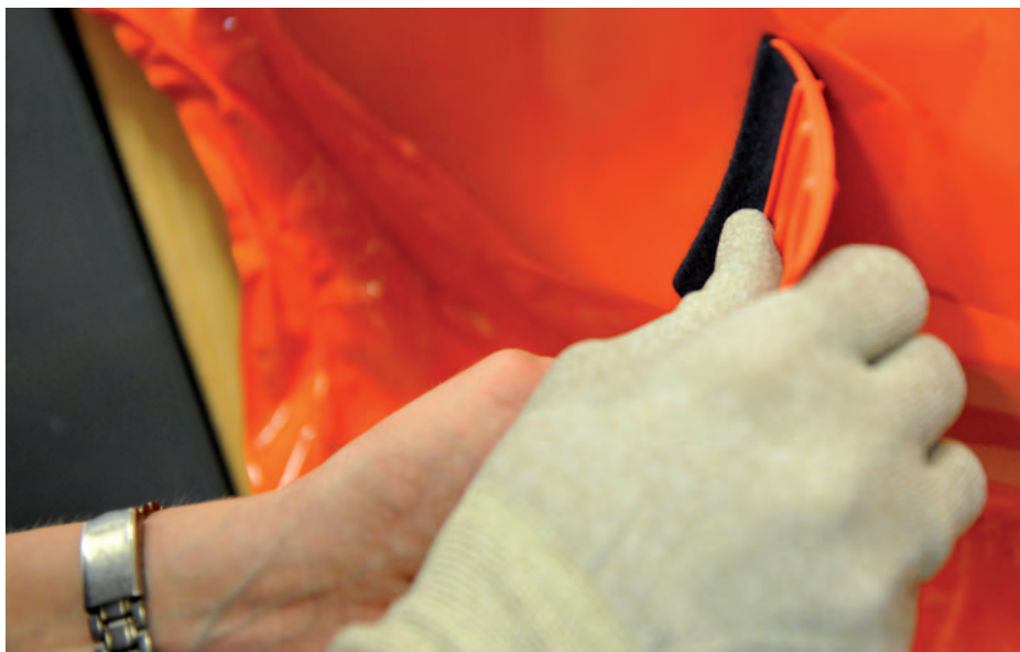
Carwraprakels buigen flexibel mee met de ondergrond.
