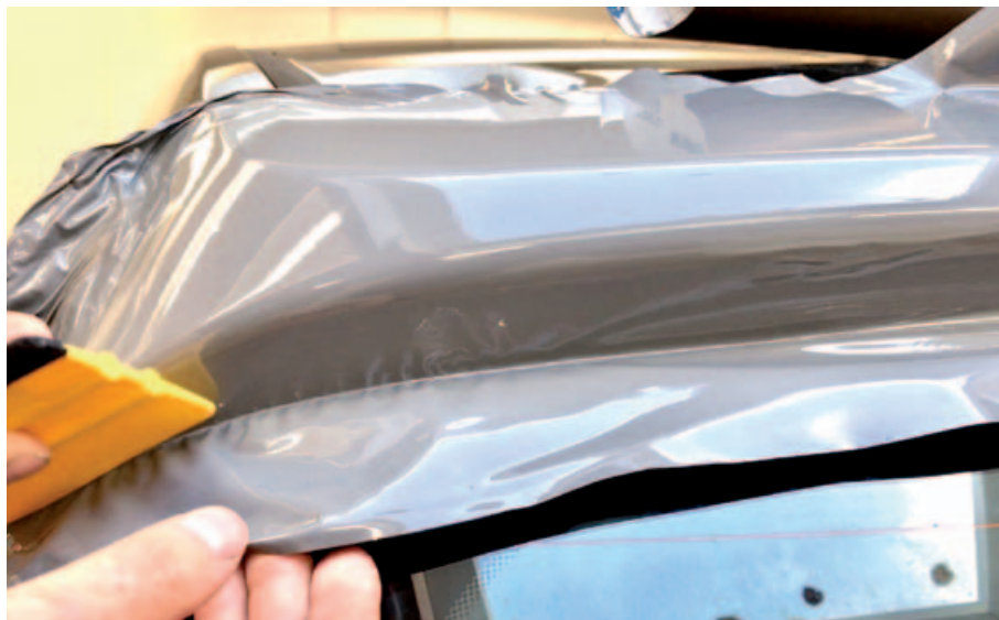
Het wrappen van bijvoorbeeld een spoiler vereist speciale techniek zodat je de folie zo weinig mogelijk uitrekt.
