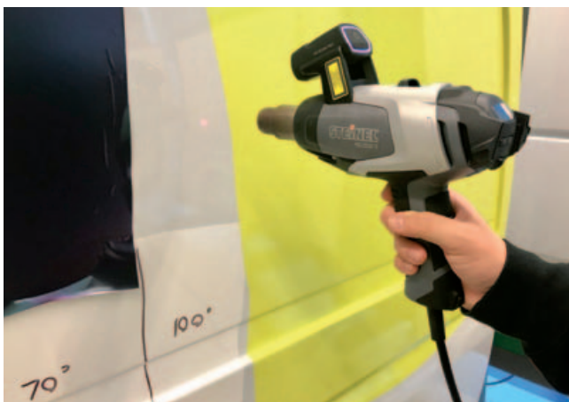
Gebruik voor het 'doodföhnen' een heatgun met een (losse) temperatuurmeter.
