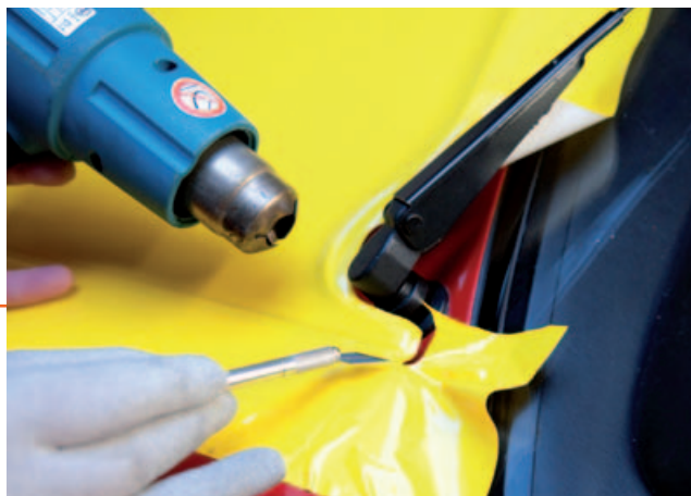
Met een klein stukje folie kun je testen hoe de folie zich gedraagt bij het wrappen van hoekjes en randjes.
