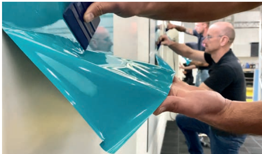
▲ Door met de viltkant van de rakel te werken, verminder je de wrijvingsweerstand.
