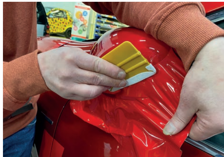
▲ Met slimme rakeltechniek kun je de folie 'opduwen' maar ook plooiën wegwerken.
