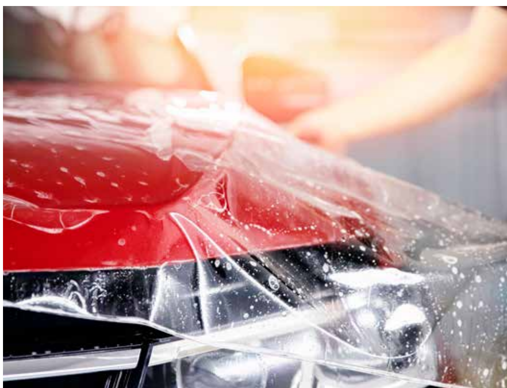
PPF wordt aangebracht met slip- en tacksolutions. Voorkom stretchmarks, stofjes, ghosting, etc.
